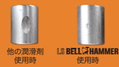
比較試験による摩耗度の違い
