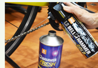
05 仕上げに防錆潤滑剤を塗布する
